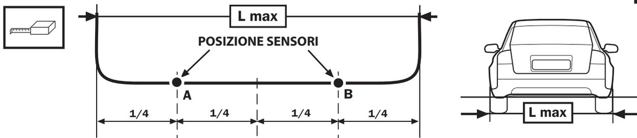
Per ottenere il massimo della performance è consigliabile posizionare i sensori in modo simmetrico e uniforme come illustrato in Fig.4, la distanza tra i sensori può variare da un minimo di 30 cm ad un massimo di 60 cm e nel caso questo non sia possibile occorre valutare il posizionamento delle capsule considerando il raggio d'azione delle stesse e eventualmente regolando di conseguenza la sensibilità.
